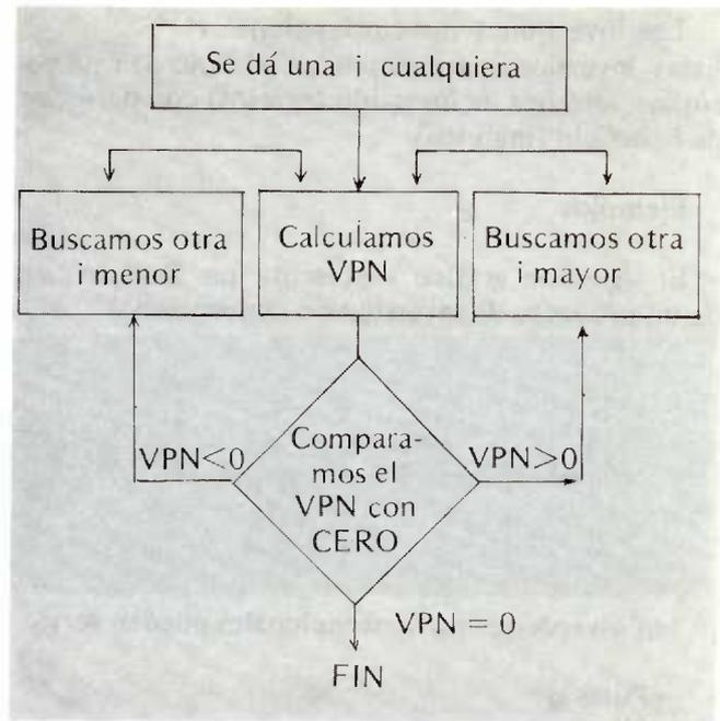
Este diagrama de flujo puede ser utilizado en un trabajo de cálculo manual o para realizar un programa para un microcomputador.
